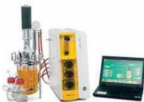
Figure II.1.7 : Photographie du fermenteur Biostat® A plus (Sartorius Stedim, Aubagne, France)
