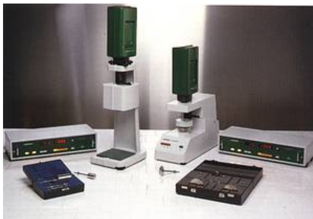
Figure II.2.1 : Photographie du viscosimètre Contraves Rheomat 115 utilisé pour les mesures de viscosité des phases organiques extractantes testées
