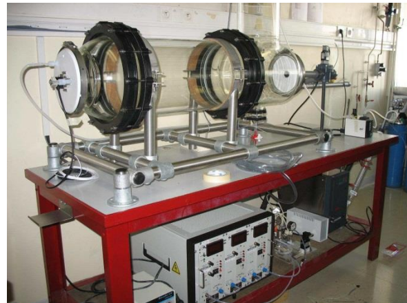
Figure C2.2. Photo du réacteur de brumisation
