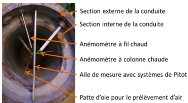
Figure M24.2. Coupe de la conduite
