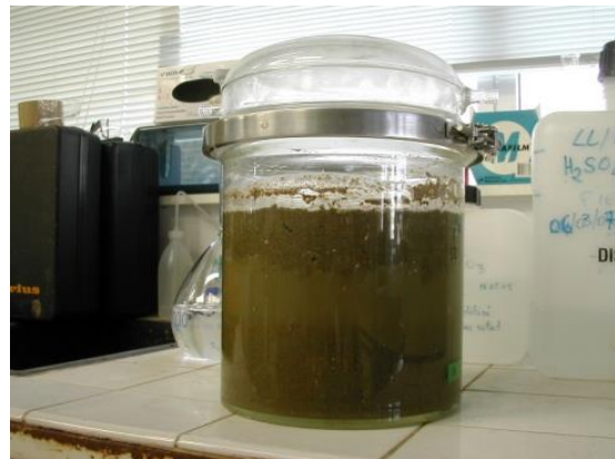
Figure C1.1. Cellule en verre contenant un échantillon du substrat à caractériser (ici du lisier)
