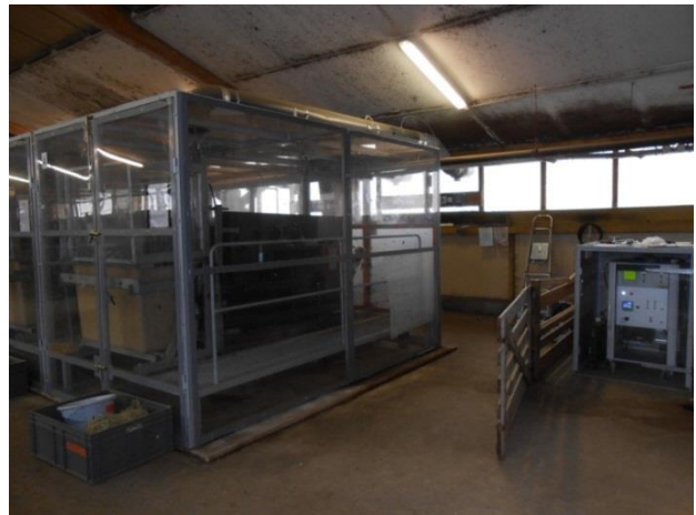
Figure C3.1. Enceinte de mesure et analyseur (photo: Maguy Eugene – INRA)
