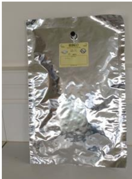
Figure M5.1. Sac d'échantillonnage en flexfoil® utilisé pour le prélèvement d'air en bâtiment d'élevage (source INRA)
