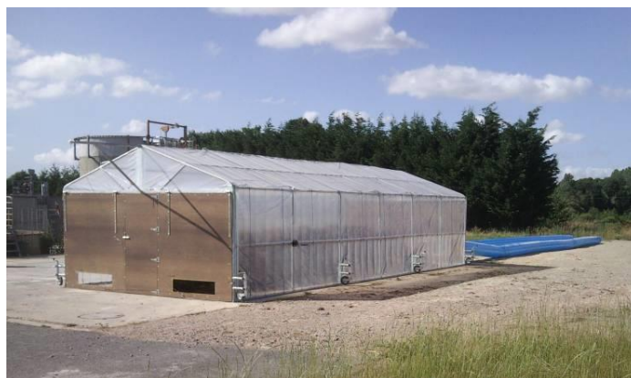
Figure C11.1. Dispositif de serre dynamique utilisé pour la mesure d'émissions gazeuses au stockage de fumier porcins
