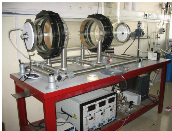
Figure C2.2. Photo du réacteur de brumisation
