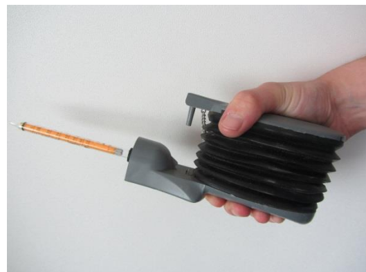
Figure M6.1. Pompe d'échantillonnage avec tube réactif colorimétrique (source : Solène Lagadec, Chambre régionale d'agriculture de Bretagne)
