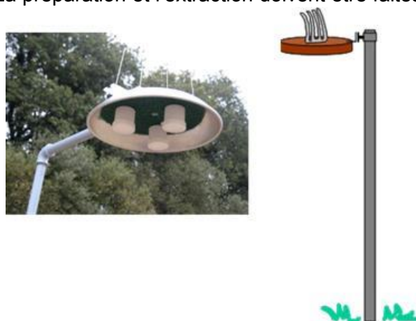
Figure M1.3. Exemple de dispositif de badges Alpha sur le terrain
